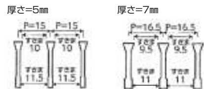
■NEWベアリングバーの厚さ/ピッチ(P) /すきま
