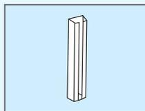
④ベースのフレームをサラビスで壁に取り付け(壁用サラビス3本付)ドライバーでネジ止めします。
